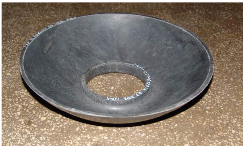
Fig. 3.1. Placa de uzură din poliamidă
