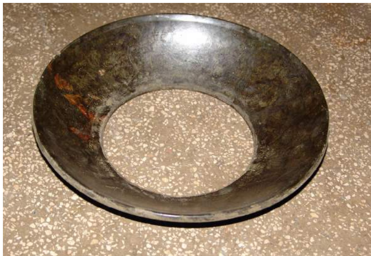
Fig. 3.2. Placa de uzură din bachelită pe suport textil
